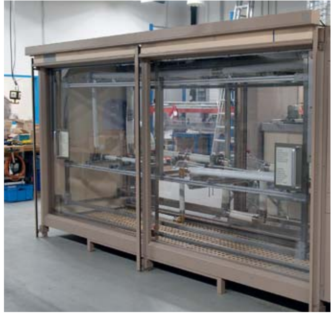
Bild 3: Ein Temperaturwechsel-Prüfstand für Langzeittests
