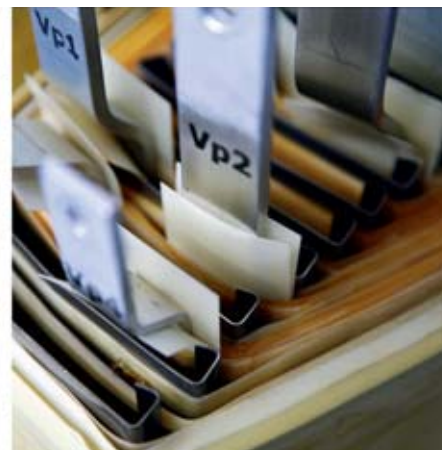
Bild 3: Die Sekundärwicklungen des Filters sind als Lagenwicklungen ausgeführt, die jeweils mit Gießharz-impregnierten Papier-Isolierlagen ausgeführt sind
