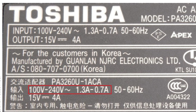
Bild 4: Das Produkt aus Spannung mal Strom muss näherungsweise gleich bleiben – auch auf dem Leistungsschild des Netzgeräts für einen Laptop (2011)
