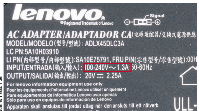
Bild 5: Es genügt jedoch, den Maximalwert anzugeben – auch wenn dieser nur bei der niedrigsten Eingangsspannung erreicht werden kann (Netzgerät für einen Laptop 2019)
