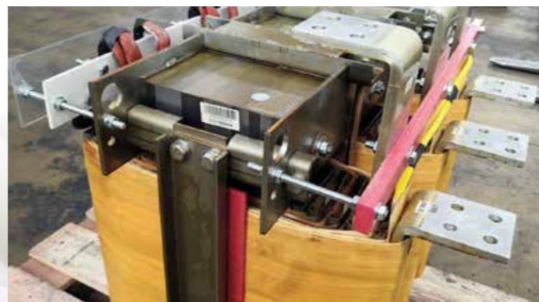
Kombination aus Längsdrossel, Streufeldtransformator und schwebendem bzw. fluktuierendem Sternpunkt.
